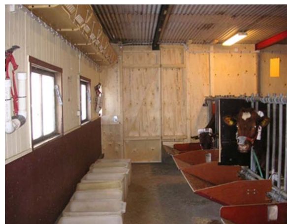
Figur 3. "Metanstuga med väggar. Uppe till vänster syns ett extra ventilationsrör som monterades in. På väggen till vänster hänger en enhet som mäter stallluftens metaninnehåll.
