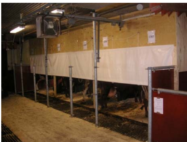
Figur 2. "Metanstugan" konstruerad för att få lägre bakgrundsvärden för metan kring båsallarna där metanmätning gjordes
