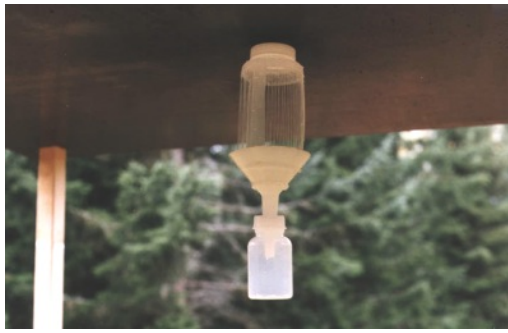
Figur 8. Fotografi av strängprovtagare. Strängprovtagaren sprayas med ca 150 ml avjoniserat vatten en gång i månaden och ett prov samlas in i behållaren som hänger under strängprovtagaren. Photo of a string collector. Once a month, the string collector is sprayed with ca 150 ml deionized water. The solution is collected in the bottle hanging below the collector.
