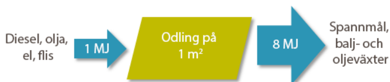
Figur 3: Vid odling av en kvadratmeter används i genomsnitt ca 1 MJ energi (exkluderat solenergin) för att driva traktorn och andra maskiner samt för att torka grödorna. Ut från odling av en kvadratmeter kommer ca 8 MJ energi bundet i grödan.
