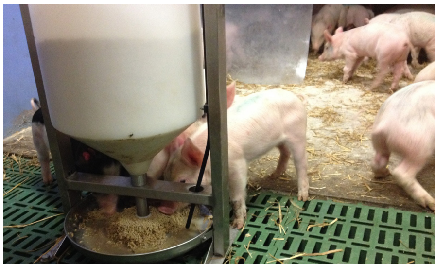
En utfodringsautomat till tillväxtgrisar som blandar foder och vatten i små mängder.
