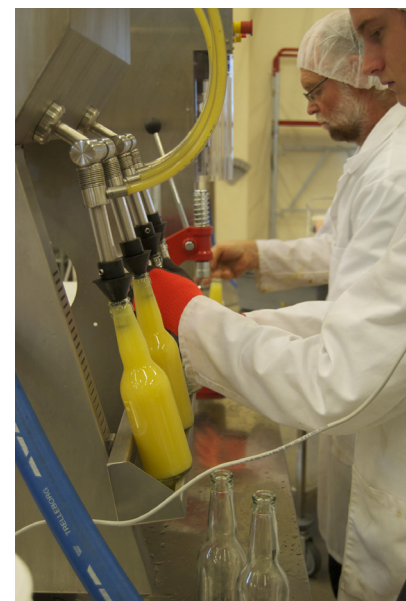
Figur 1. Fyllning av must på 33 cl flaskor med kronkork. Vid en skonsam hantering och lämpligt sortval kan färgen på en ofiltrerad (fiberik) äpplemust bli gyllengul. Tillräcklig utbildning, tydliga rutiner för handhavande av utrustning och kontroll av kritiska styrpunkter samt god personlig hygien är en förutsättning för tillverkning av säkra produkter med hög kvalitet. (Foto: Kimmo Rumpunen).
