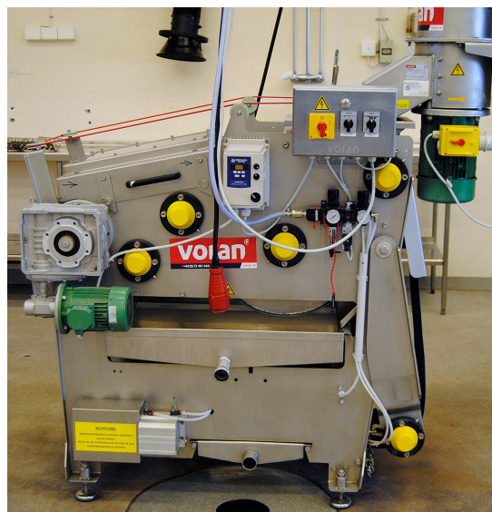
Figur 2. Bältpress från Voran för kontinuerlig pressning av äpple till fiberrik must. Kapacitet: 250–350 kg/timme. Krossmassan faller direkt i bältpressen och förs av bältet mellan olika valsar där musten pressas ut och samlas upp i ett kar. Från karet pumpas musten sen till en tank med flytlock för sedimentering. Pressresterna samlas upp i en äpplebinge. Pris: ca 150 000 kr för bältpressen. (Foto: Kimmo Rumpunen).
