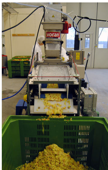
Figur 2. Bältpress från Voran för kontinuerlig pressning av äpple till fiberrik must. Kapacitet: 250–350 kg/timme. Krossmassan faller direkt i bältpressen och förs av bältet mellan olika valsar där musten pressas ut och samlas upp i ett kar. Från karet pumpas musten sen till en tank med flytlock för sedimentering. Pressresterna samlas upp i en äpplebinge. Pris: ca 150 000 kr för bältpressen. (Foto: Kimmo Rumpunen).
