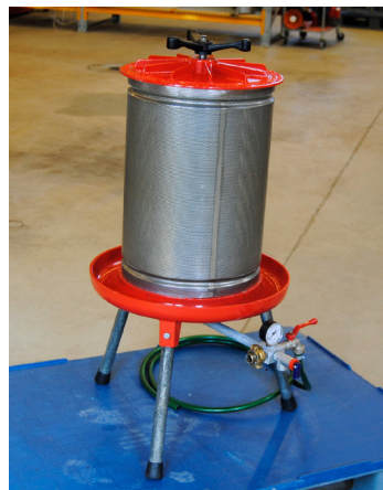
Figur 1. Liten vattenpress på 40 liters volym. Priset varierar beroende på tillverkningsmaterial där rostfria vattenpressar är dyrare men att föredra. Pris: icke rostfri 40 liters vattenpress ca 8 500 kr, rostfri ca 12 500 kr. (Foto: Kimmo Rumpunen).
