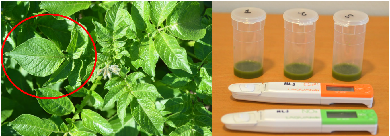
Bild. 1. Vänster bild visar en potatisplanta där det fjärde senast fullt utvecklade bladet är markerat med en röd cirkel. Höger bild visar en nitratmätare (grön), en kalciummätare (orange) från Horiba samt bladsaft förvarad i burkar med lock inför mätning. Foto: Helene Larsson Jönsson
