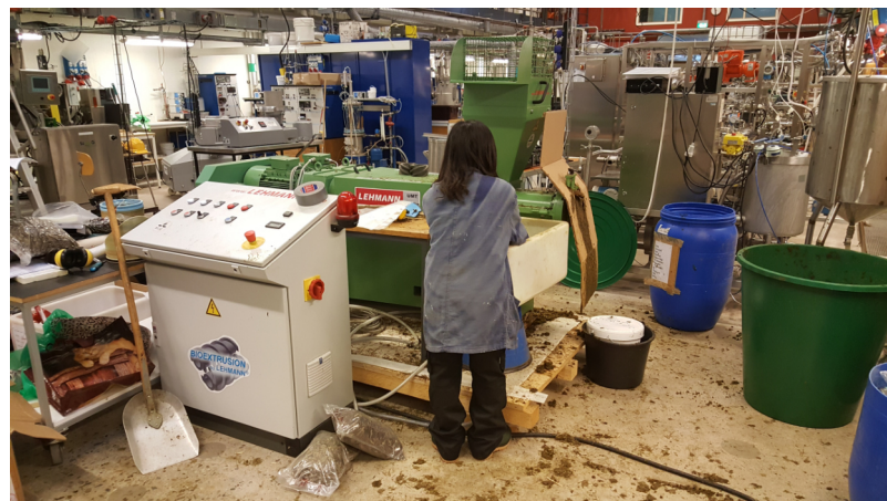
Figur 1. Bioextrudern som har används för att förbehandla vallfodret i djurförsöket. Fotograf Thomas Prade.
