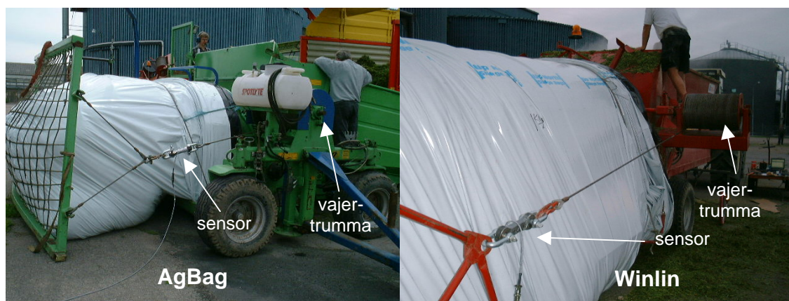
Figur 5. Position av vajerspänningssensorer på AgBag- och Winlin-packarna.
