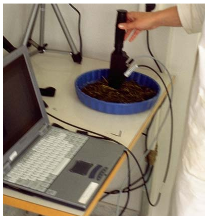
Figur 3. Mätning med kontaktprobe i ensilage.
