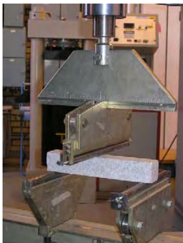
Figur 3.2. Provutrustning och provkropp med standardformatet 50x50x300mm
