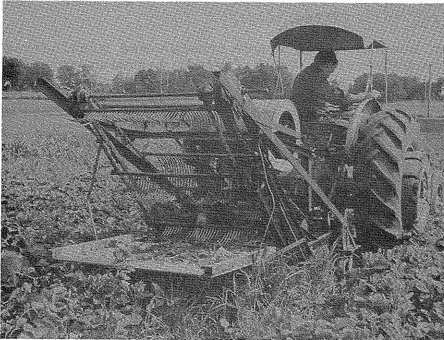
Bild 20. Repande skördemaskin från ISU (Denison & Buchele, 1966)
