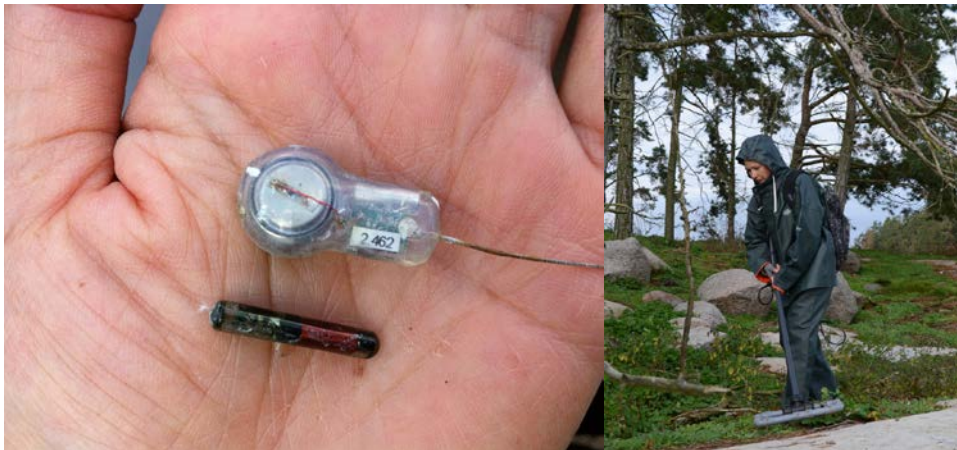
Två sorters fiskmärken användes i projektet. I bilden till vänster; Telemetri/Radiomärke överst och PIT-märke underst. I bilden till höger scannas ön Lindholmen efter PIT-märken. Foto: Kristin Öhman.
