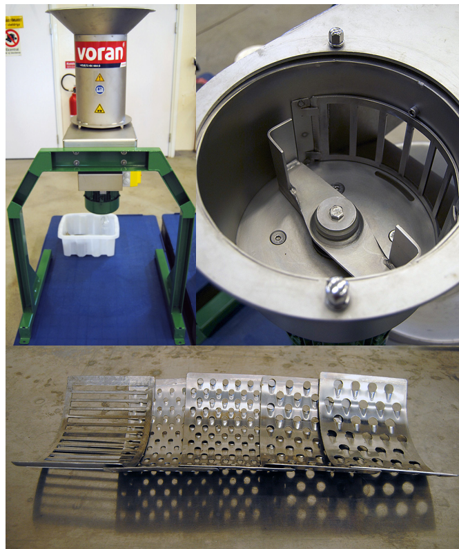
Figur 1. Elektrisk fruktkvarn typ Voran RM 1.5 (rivjärnsmodell med utbytbara rivjärn). Kapaciteten är upp till 650 kg per timma. Motorkraft: 2.2 kW. Bredd: 35 cm. Längd: 76 cm. Höjd: 125 cm. Vikt: 25 kg. Pris: ca 13 000 kr. Samma typ av kvarn används ofta i kombination med tvätt och transportör vid rationell småskalig musttillverkning. (Foto: Kimmo Rumpunen).
