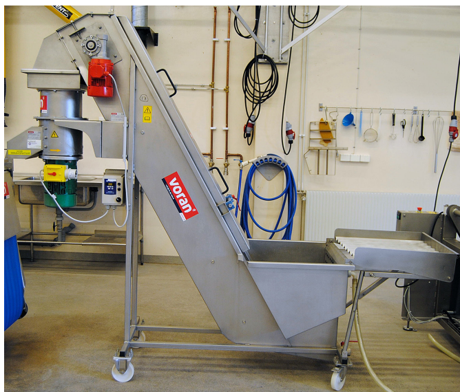
Figur 2. Tvätt och transportör med centrifugalkvarn och svängbar eller fast kross (rivjärnsprincipen) typ Voran (SA). Rengöringssystem består av sorteringsgaller, tvättkar, vattenstril, kedjedriven transportör och monterad centrifugalkvarn RM2. Frammatningshastigheten är steglöst justerbar. Pris: ca 70 000 kr. (Foto: Kimmo Rumpunen).
