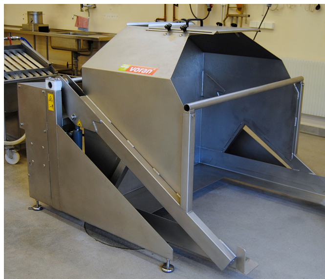
Figur 3. Lyft- och tömningsanordning för äppelådor typ Kreuzmayr GKE. Utrustningen består av en rostfri elektriskt driven hydraulisk lyft med tömningslucka. Kapacitet 500 kg. Lådstorlek: 1200x1200x780 eller 1200x1000x780 mm. Tömningslucka: 500x799 mm. Pris ca 63 000 kr. (Foto: Kimmo Rumpunen).
