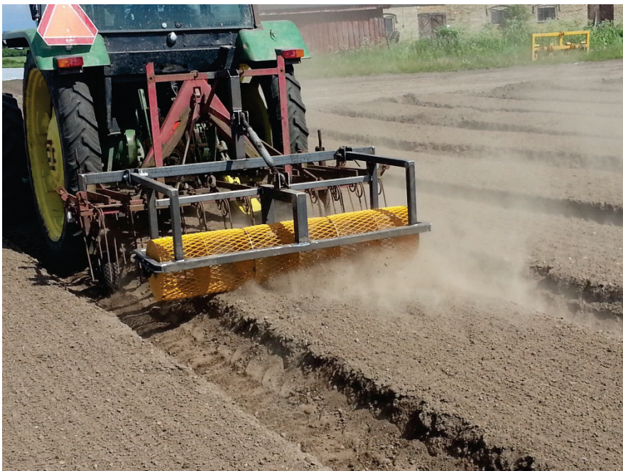
Figur 4. Utrustning för falska såbäddar på upphöjd bädd. Redskapet är en modifierad långfingerharv utrustad med en gallervält bak som "bärrulle" för en mer exakt djuphållning. Foto: David Hansson.
