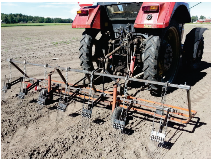
Figur 6. Utrustning för selektiv harvning i morotosraden med ett "harvaggregat" per morotsrad. Foto: David Hansson.
