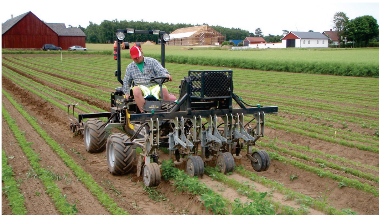
Figur 5. Utrustning för selektiv harvning i morotsraden. Radhackan utrustades med ett "harvaggreat" per morotsrad, d.v.s. tre harvaggreat per bädd. Foto: David Hansson.
