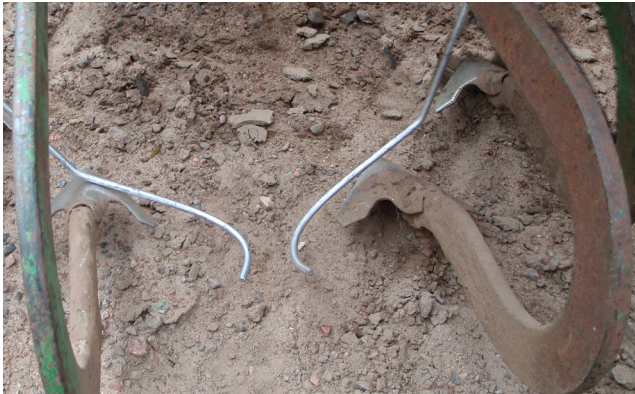
Mjuk rundade skrappinnor som preliminärt monterats på en radhacka Foto: David Hansson
