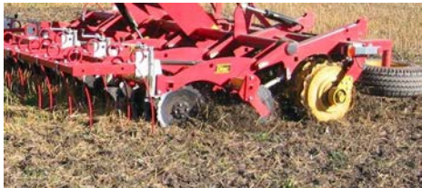
Carrier består av två rader med tandade och koniska tallrikar som bearbetar stubben.
