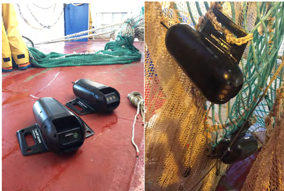
Figur 7.5. Vänster: Kameran och ljusenheten som användes under försöken. Höger: Kameran (nederst) och lampan knöts upp i risten inför varje hal och togs ned efter varje hal.
