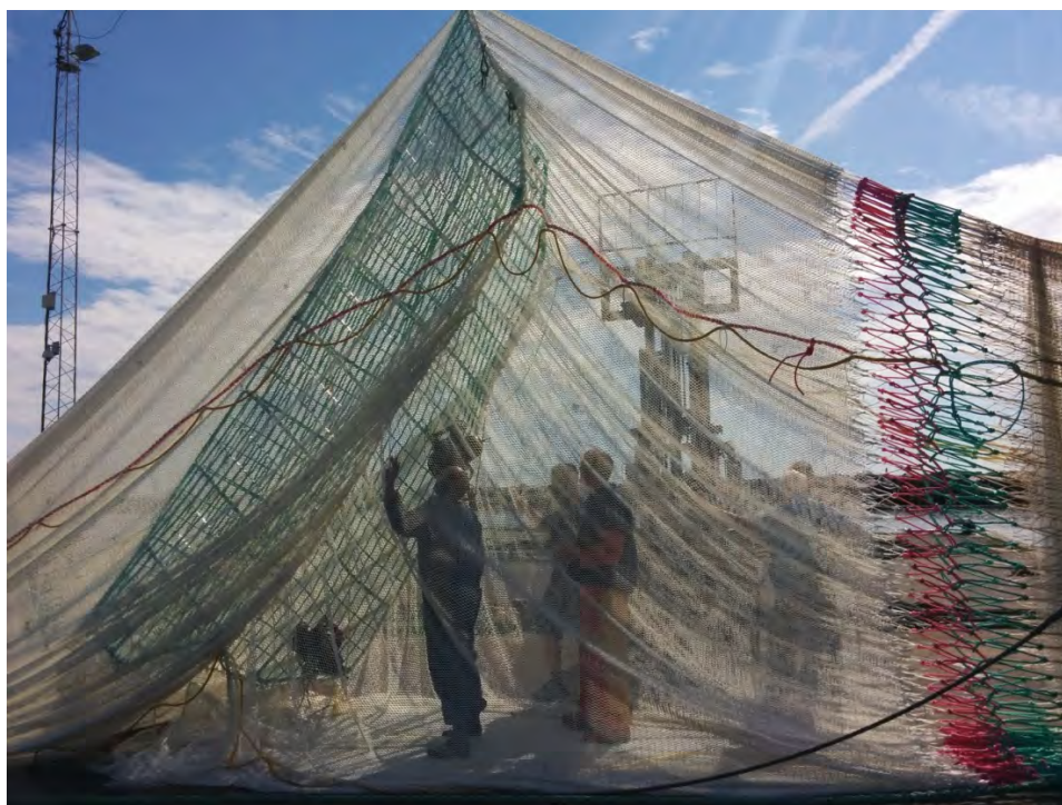
Figur 7.2. Kamerapositioner provades ut och märktes upp i risten i samband med att det monterades i trålen. På kaj i Skagen, augusti 2015.
