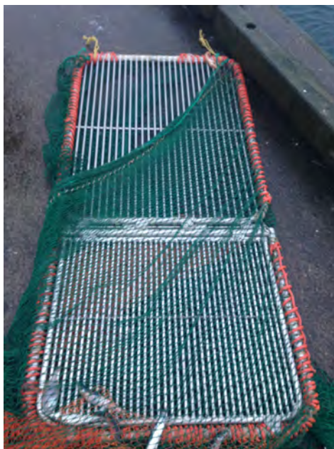
Figur 1.1. Bilden visar den kombinationsrist som testats i försöket. Risten består av två delar: Den lagstaddade artsorterande 19 mm risten i övre delen och en enkelt utbytbar underdel med smalare spjälbredd för utsortering av småräka (9-11 mm).
