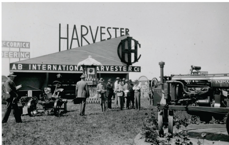
Bild 5:8. International Harvesters utställningsmonter vid lantbruksmötet i Stockholm 1930. Till höger snurrar en Farmall kring sin egen bakaxel och till vänster syns uppbyggnaden av en McCormick 10-20 med motorn monterad i sin "boiler-plate frame". Bild i SMP:s arkiv.
