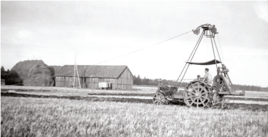
Bild 2:3. Asea/Junes elektriska plog under provkörning vid Nordanby gård utanför Västerås 1923. Foto ur Svenska Motokulturföreningens arkiv, KSLA.
