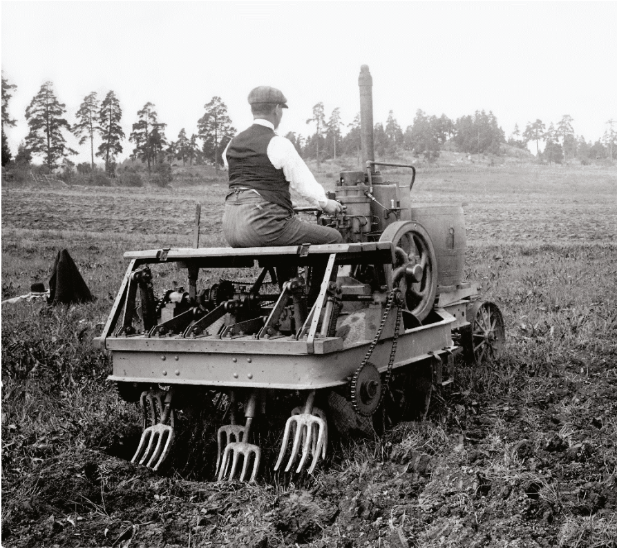
Bild 2:4. Ingenjör Ekehorns gaffelkultivator vid provkörningen 1912. Grävgaflarnas roterande rörelse skulle vända jorden i likhet med grävgrepar. Flera förbättrade versioner av maskinen utkom under 1910-talet. Foto ur Svenska Motokulturföreningens arkiv, KSLA.
