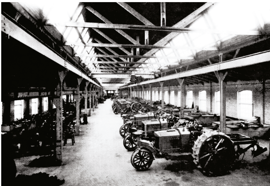
Bild 5:4. Motorplojen June. Den nyuppförda verkstadshallen i Bankeryd där montering pågår av ett tjugotal motorplögar ca 1919–20.
