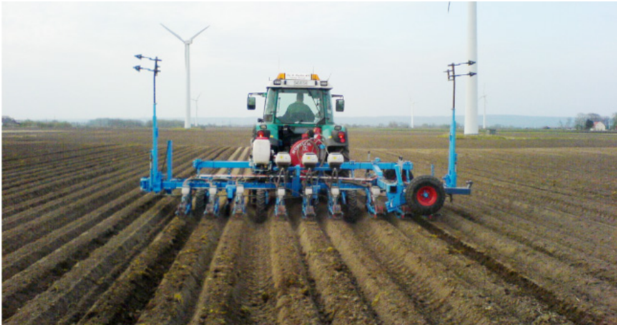
Figur 2. Sådd av morot på kupfräst bädd (drill) med precisionssåmaskin. De tre raderna i mitten av såmaskinen ges en sammyllad gödselgiva med ett fast gödselmedel, i detta fall MAP (NP 12-23). De tre vita behållarna i mitten och en bit ovanför såmaskinen, doserar ut den sammyllade gödningen. Foto: Sven-Erik Svensson.
