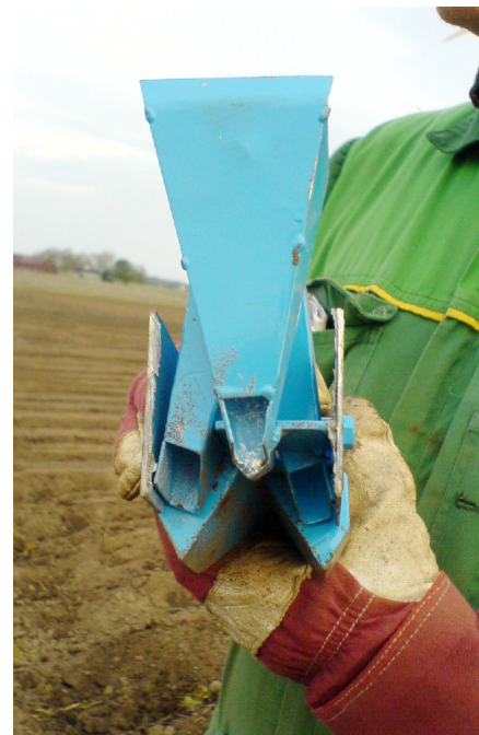
Figur 4. Såbill för sammyllad gödsling vid dubbelradssädd. Foto: Sven-Erik Svensson
