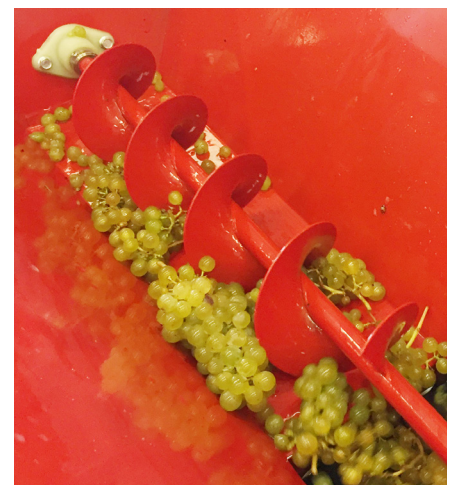
Bild 3. Avstjälkning av vindruvor med hjälp av skruv
