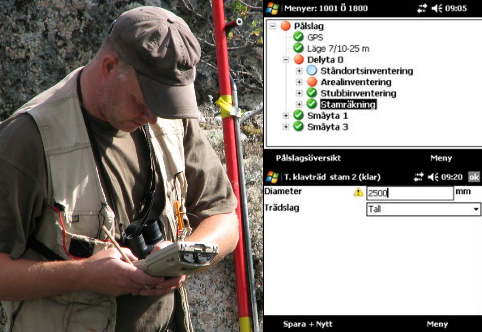
Figur 4. Exempel på skärmbilder från den handdator som RT använder i fält. Övre bilden visar status för arbetsmoment (grönt=klart, rött=innehåller fel/ej komplett, vitt=ej påbörjad). Nedre bilden visar att en varningstriangel tänts framför ett variabelvärde som är ovanligt, orimligt eller felaktigt, i detta fall varnas för om diameter i brösthöjd överstiger 500 mm. Fotograf:Ola Borin, SLU
