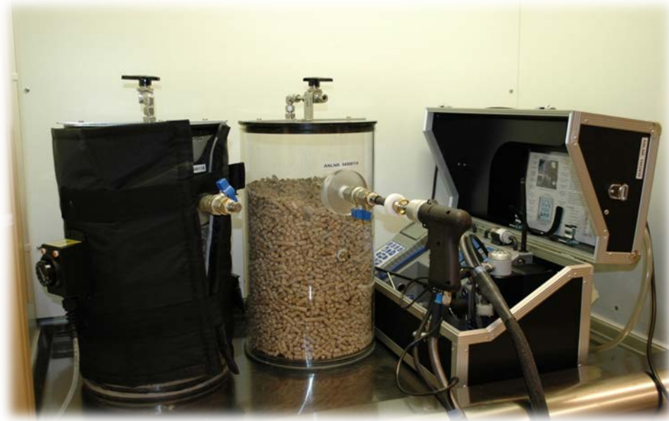
Figur 80. Emissionsmätningar under lagring av pellets vid olika temperaturer
