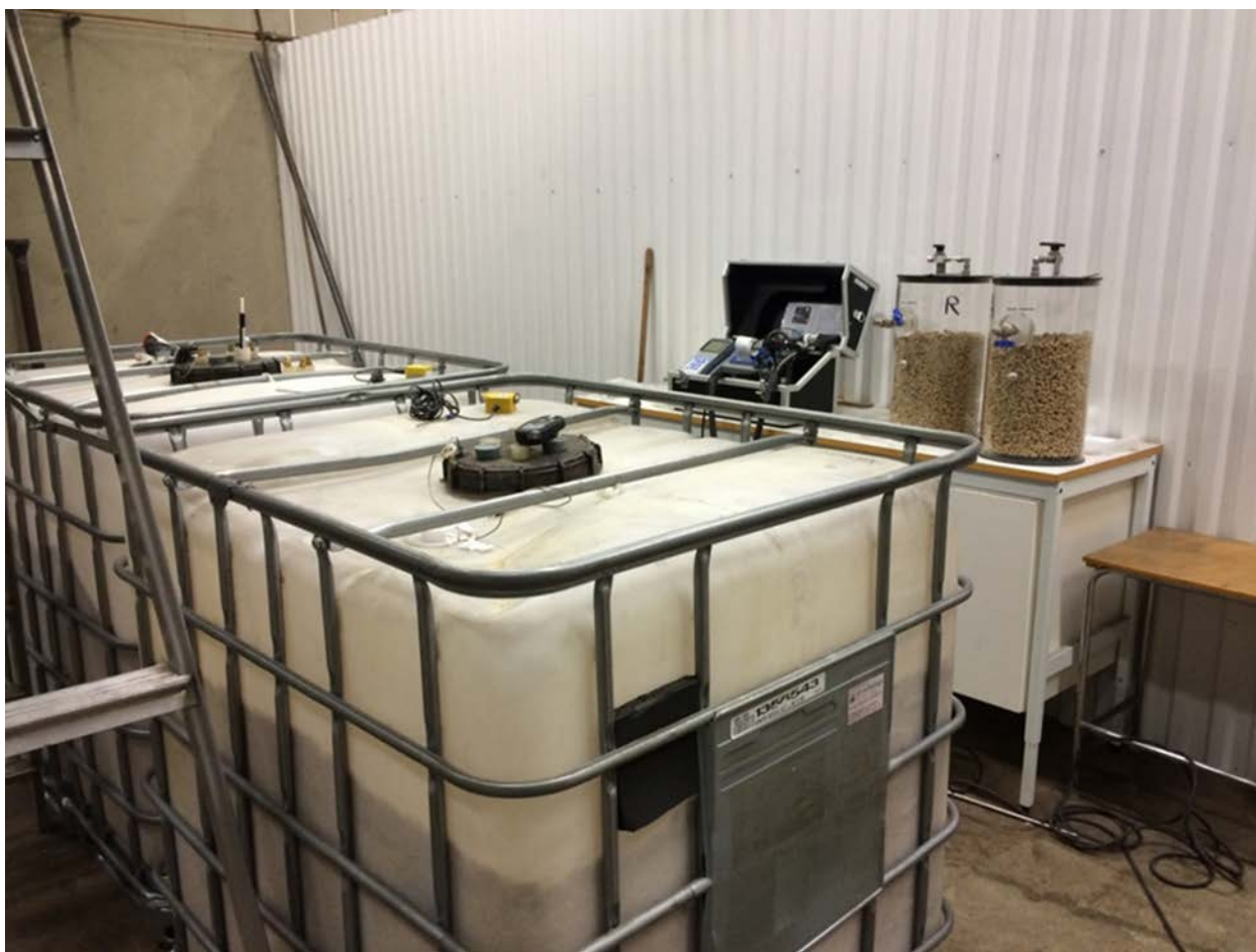
Figur 87. De två gastäta behållarna samt 2 små behållaren som har använts för övervakning av emissioner
