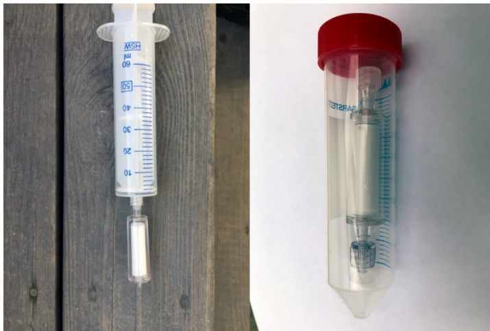
Figur 8. Vänster: Sterivexfilter och 50 ml spruta som används vid filtreringen. Höger: Sterivexfiltren läggs sedan i ett 50 ml Falconrör för förvaring. Foto: Per Sundberg, ©SeAnalytics AB.
