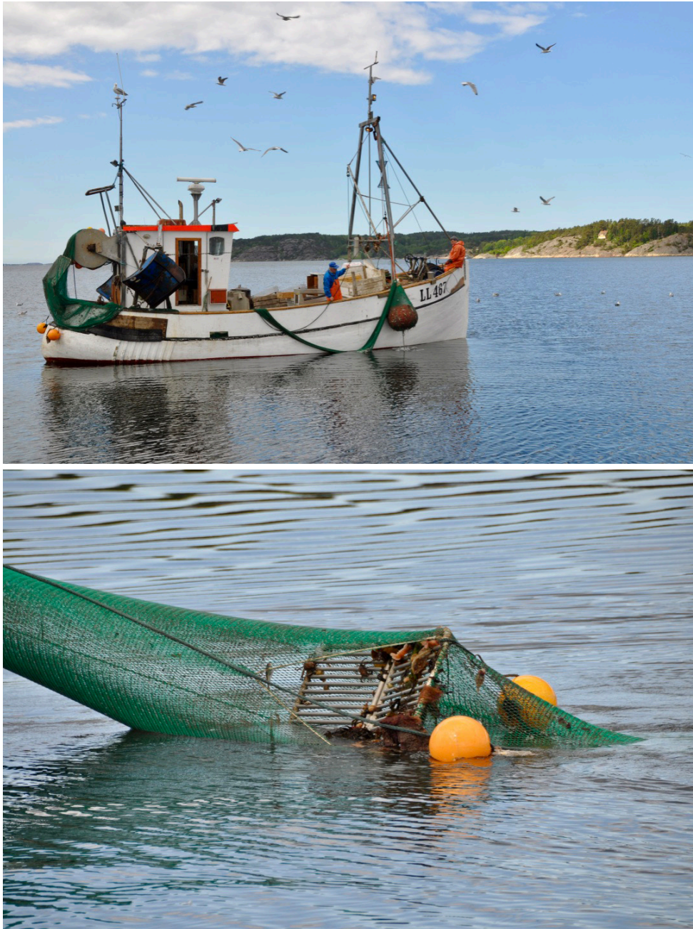
Figur 13. Räkfiske med rist är tillåtet djupare än 60 m innanför trålgränsen i Koster-Väderöfjorden och i ett avgränsat område i Gullmarsfjorden. Framför risten finns en flyktöppning i taket på trålnätet genom vilken fisk och större skaldjur som inte kan passera ristgallret släpps ut. Foto: Mattias Sköld.
