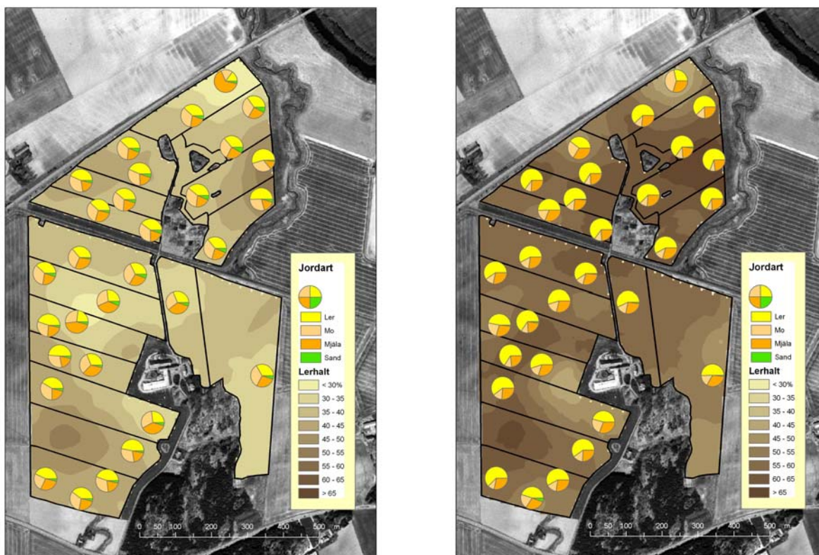
Figur 3. Jordart (lera, mjäla, mo och sand, %) i provtagningspunkterna i matjord (till vänster) och alv (till höger) vid karakteriseringen med interpolerad lerhalt (%) i bakgrunden.
