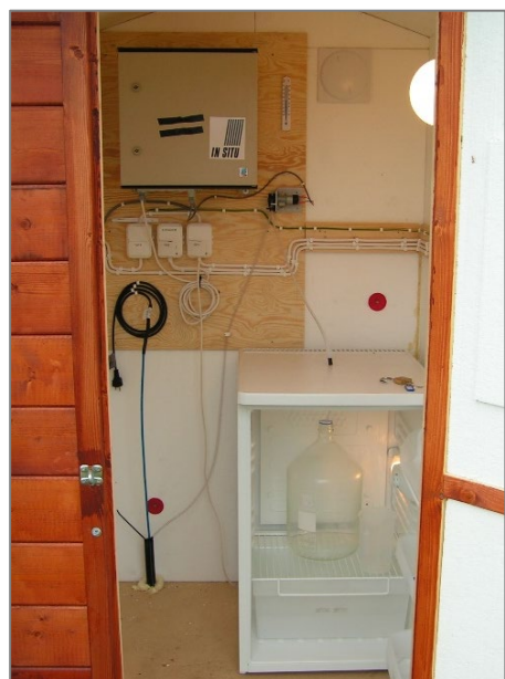
Figur 4. Utrustning för flödesproportionell provtagning i typområde I28.
