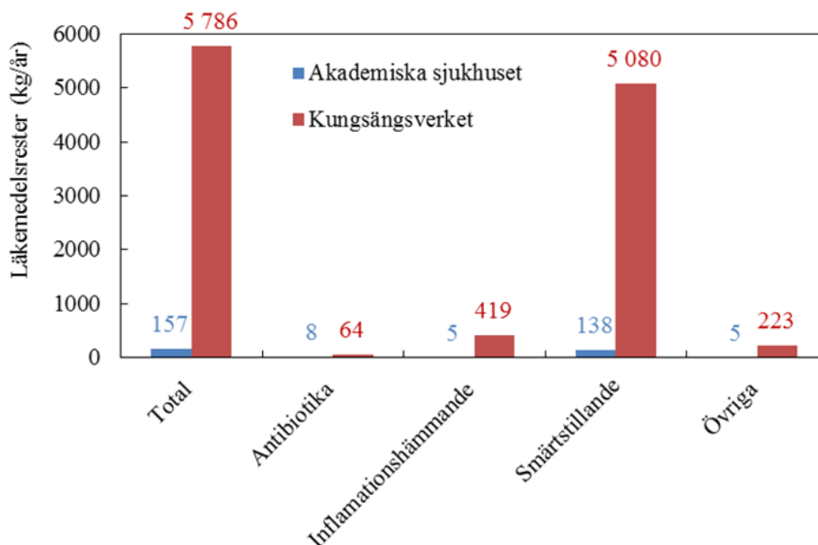
Figur 4. Massflöden av totala mängder analyserade läkemedel inom olika terapeutiska grupper i blandat kommunalt avloppsvatten till Kungsängenverket i Uppsala jämfört med flödena i avloppsvattnet från Akademiska sjukhuset (Landstiget i Uppsala län, 2005).
