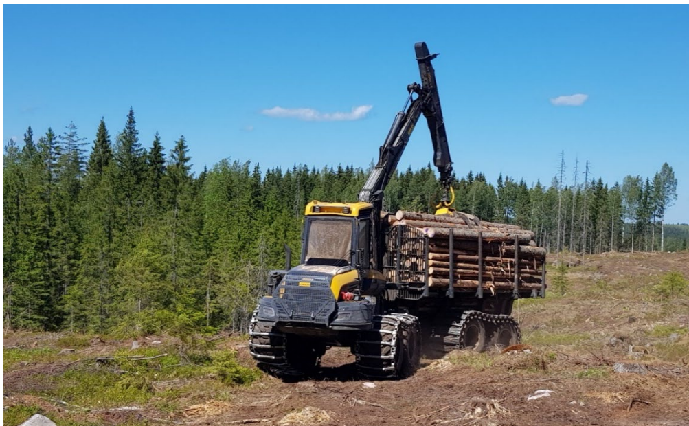
Figur 1. En fullastad skotare på väg mot avlägget. Totalvikt ca 40 ton (20 ton maskin, 16 ton last och 4 ton boggiband). Foto: Tomas Nordfjell.
