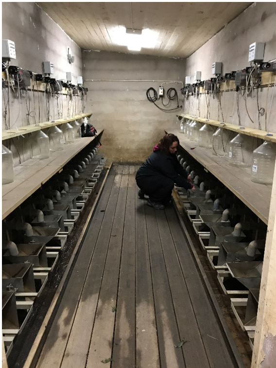
Figur 4. Bilden till vänster visar mätstationen där dräneringsrör från varje separat ruta inkommer. Flödet bestämdes kontinuerligt med vippkärl kopplade till en datalogger, som även styrde provtagningen (även bild ovan). Vattenprov togs och samlades i glasflaskor i proportion till avrunnen mängd dräneringsvatten, varefter analys gjordes av samlingsprovet var 14:de dag. Mätstationen är delvis under jord och håller därför låg temperatur även under sommaren.
