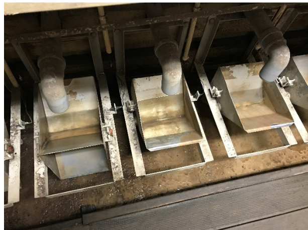
Figur 4. Bilden till vänster visar mätstationen där dräneringsrör från varje separat ruta inkommer. Flödet bestämdes kontinuerligt med vippkärl kopplade till en datalogger, som även styrde provtagningen (även bild ovan). Vattenprov togs och samlades i glasflaskor i proportion till avrunnen mängd dräneringsvatten, varefter analys gjordes av samlingsprovet var 14:de dag. Mätstationen är delvis under jord och håller därför låg temperatur även under sommaren.
