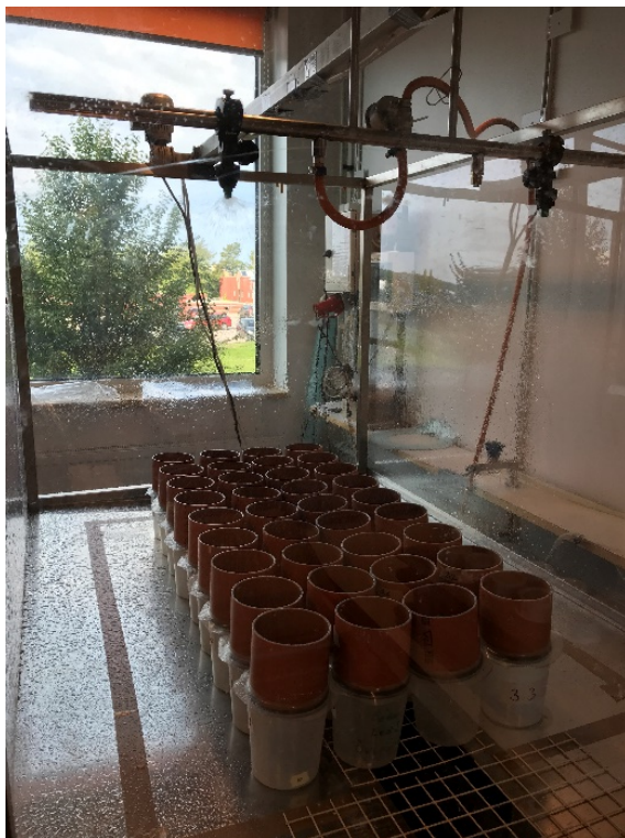
Figur 6. Bilden till vänster visar regnsimulatorens med de 18 jordproverna. De högra bilderna visar flaskorna som innehöll det avrunna vattnet efter regnsimuleringen (överst) och apparaturen för mätning av elektrisk konduktivitet (nederst).
