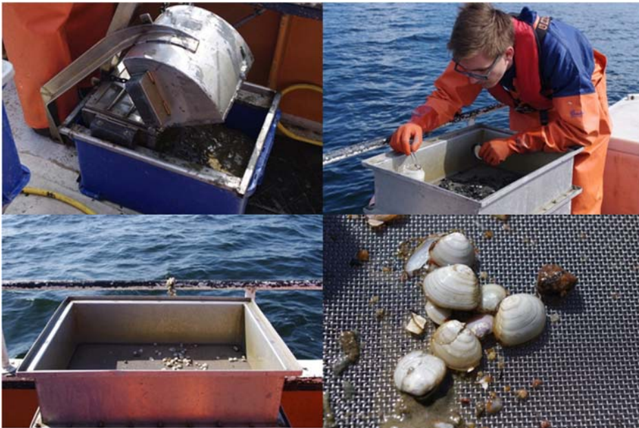
Figur 6. Överst till vänster: Van Veen-huggaren töms på sediment innehållande bottenfauna i plastback. Överst till höger: Personal på SLU Aqua plockar bottenfauna från sållet till provburk. Nederst till vänster: Materialet i bottenhugget spolas försiktigt med havsvatten genom ett 1 mm såll för att samla upp de bottenlevande djuren. Nederst till höger: Östersjömussla ( Macoma balthica ).
