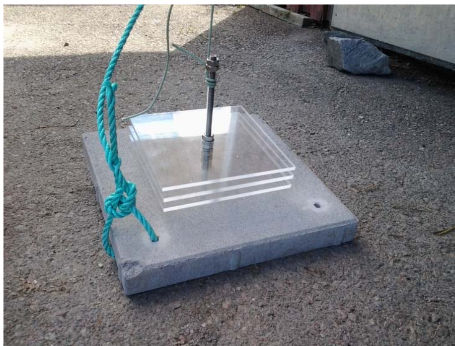
Figur 7. Landforsplatta som används vid provtagning av hårbottenfauna. Åtta stycken Landforsplattor placeras ut vid varje station på cirka fyra meters djup.
