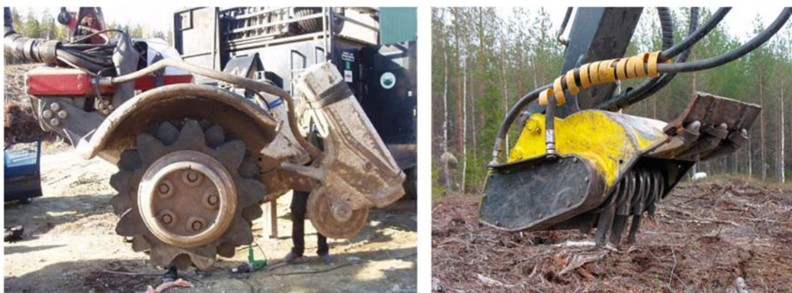
Figur 8. Kranspetsmonterade aggregat för riktad skogssådd som inte längre används: Humax (till vänster) från Humax Forest AB i Hammerdal, Jämtland, och Havel-fräsen från Havel Oy i Ilomantsi, Finland. Bristfälligt markberedningsresultat var huvudanledningen till varför båda specialaggregat inte längre används (Nilsson 2009; Helenius & Saarinen 2013). Foto: Ida Nilsson och Pekka Helenius.
