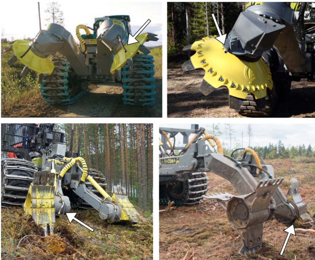
Figur 6. Mekaniserad skogssådd genom såddrör monterade på moderna harvaggregat (överst) och höglägningsaggregat (nederst). Harvaggregat med standardharvtallrikar (med grävmaskinständer, vänster) och en nyutvecklad harvtallrik (med slitstarka plattor, höger). Höglägningsaggregat med sidomonterade såddrör med standardmässiga treuddiga rivhjul (med grävmaskinständer, vänster) och nyutvecklade treuddiga rivhjul (med ”nästan-mikropreparerande” skärtänder på ett rivhjul och slitstarka plattor på det andra rivhjulet, höger). De vita pilarna visar var fröna kommer ut. Foton: Bracke Forest AB.
