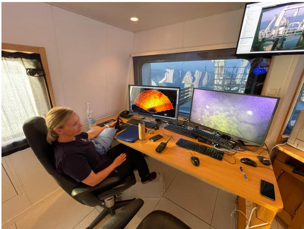
Figur 5. Arbetsstationen i forskningsfartyget Sveas "operation centre". På vyn till höger syns filmen från UWTVn i drop-mode, dvs. hängande ca 40 cm ovan botten. Till vänster syns vyn från UWTV:ns multibeamsonar som tecknar miljön, i det här fallet stenbumlingar och eventuella hinder framför UWTV:n.
