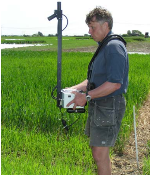
Bild 1. Yaras handsensor. En uppåtriktad sensor mäter infallande ljus och en riktad snett neråt mäter hur mycket ljus som reflekteras från grödan. Data registreras i en handdator kopplad till själva sensorn.
