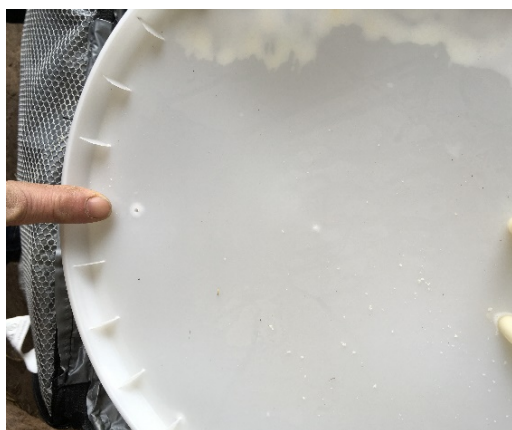
Bild 22 Lufthål i tättslutande lock underlättar flödet. Foto Annelie Carlsson
