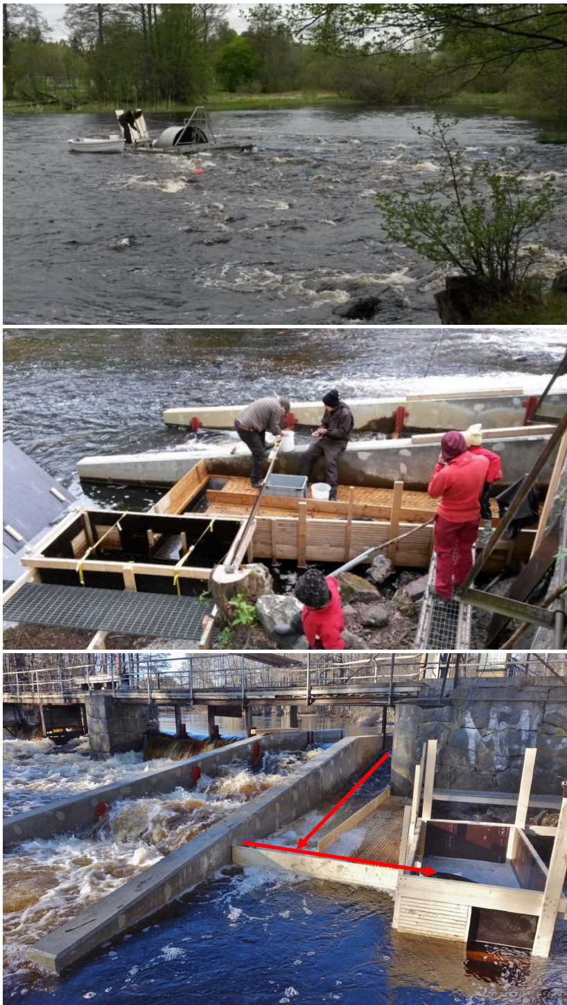
Figur 6. Smoltfällor som använts i Testeboån under åren 2014-2021. Den övre bilden visar smolthjulet i Forsby och de två nedre visar Wolf-fällan vid dammen i Strömsbro. De röda pilarna i den nedersta bilden visar hur smolten fångas upp i fällan och förs via en tvärgående passage till en sump (till höger) som vittjas dagligen.
