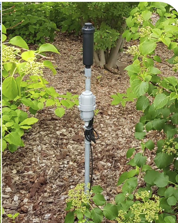
Sändare, den grå boxen, för markfukt monterad på en bevattningsstolpe. Sensorn sitter under jord på den svarta kabeln. Foto: Anders Kristoffersson
