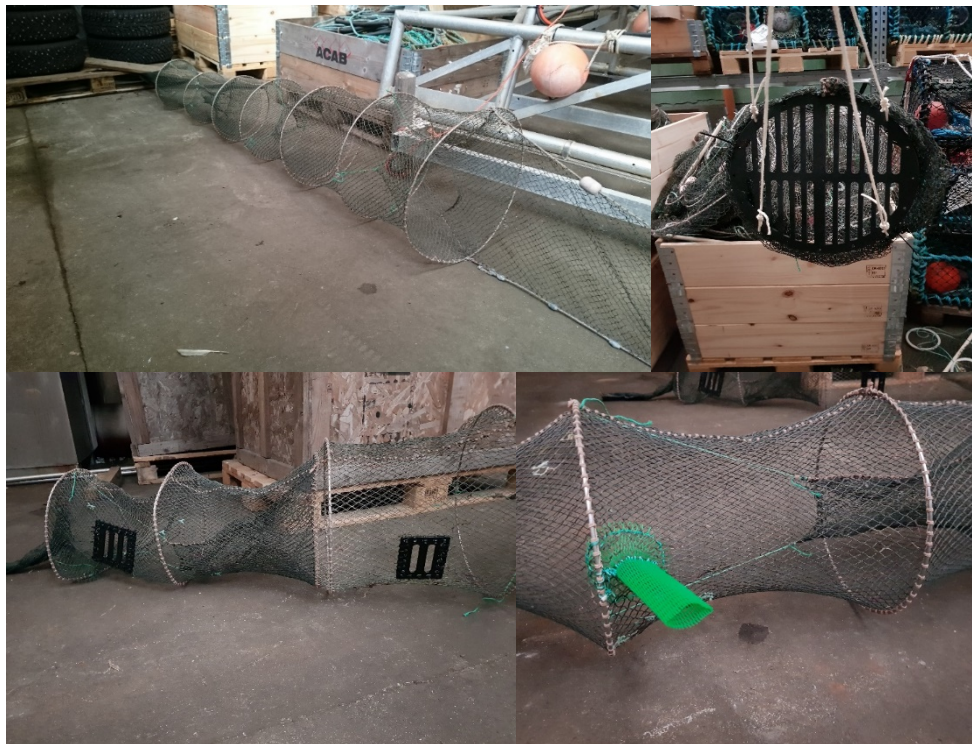
Figur 1. Högst upp till vänster: En omodifierad ryssja av det slag som användes i experimentet. Högst upp till höger: ändrist, längst ner till vänster: sidrist och längst ner till höger: ålstrumpa.
