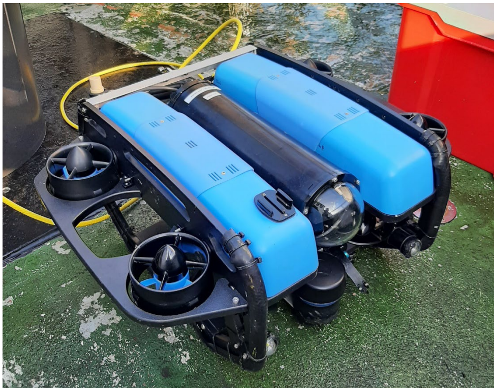
Figur 3. ROV (Remotely Operated Vehicle) som användes för dokumentation av utsläppstuben och omgivande botten.
