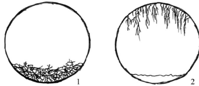
Rötter i dagvattenledning (1) och spillvattenledning (2). Illustration: Hanna Fors
