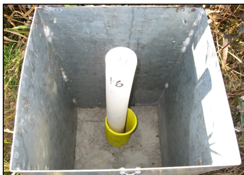
Figur 6. Grundvattenrör. Foto: Maria Blomberg
