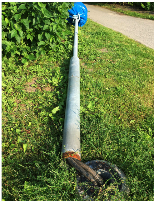
Varken belysningsstolpen som göms bakom frodig grönska eller den som rostet sönder bidrar till trygg utemiljö.
