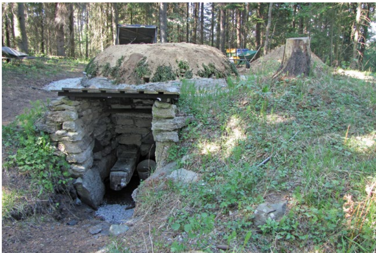
Figur 179. Gotländsk tjärdal, sojde, färdig för att tändas på så snart vädret tillåter. Tjärdalen är byggd av kådriska stubbar som kluivits och staplats, och därefter täckts med granris och sand. Tjäran leds genom ett rör som mynnar ut under taket i bildens förgrund. Gammeln, Gotland, maj 2018. Foto Tommy Lennartsson.
