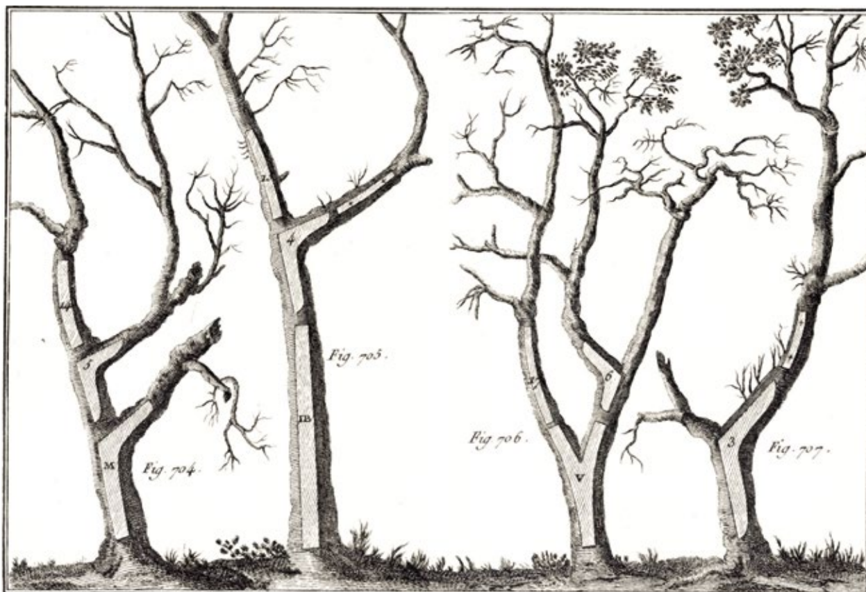
Figur 169. Plansch från det franska verket Encyclopédie méthodique. Marine , från 1783, visande olika sortiment av ekvirke till skeppbyggnad från stammar och grenvinklar, PDM. Med denna som förlaga gjorde skeppskonstruktören Fredrik Henrik af Chapman en liknande plansch för svenska förhållanden, där han också lade till granknän (Eliasson & Nilsson 1999.)
