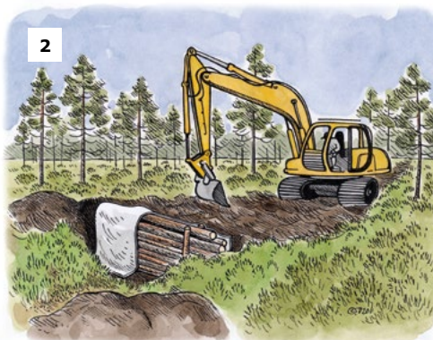
Figur 4.18. Jutesäckar som fylls med material tillgängligt nära dämmningsplatsen (torv) kan bli ett enkelt och flexibelt dämme som förankras med trästolpar huggna på plats. Dämnet kan till exempel användas vid komplettering och reparation av andra dämmen och dämning i små och känsliga källmiljöer (illustrationer: Tupu Vuorinen).
