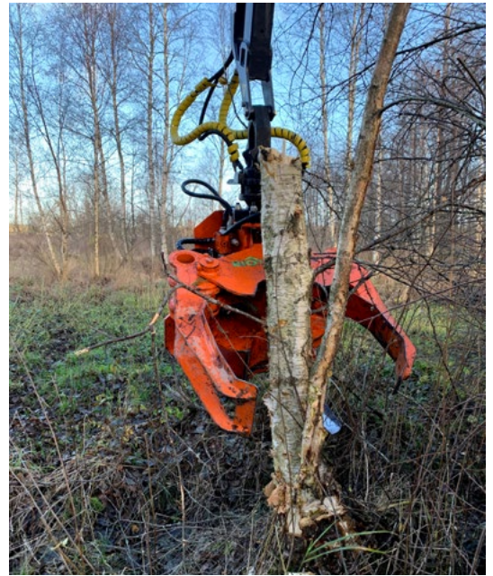
Figur 8.6. En finskproducerad skotare, Logbear 4000, som går att ställa om till skördare. Skotaren på bilden är utrustad med en kombinerad klipp- och skotargrip som kan klippa stammar på upp till 15 cm i diameter. Denna kombination finns inte längre då motor och pump till hydrauliken inte matchade perfekt. Vid tillräckligt hög efterfrågan går det dock att framställa något motsvarande (foto: Frej Eriksson).
