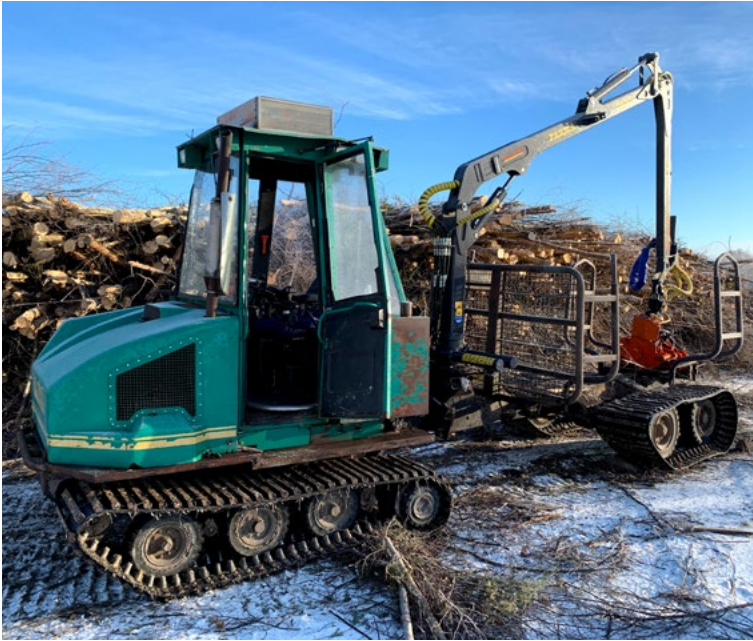
Figur 8.6. En finskproducerad skotare, Logbear 4000, som går att ställa om till skördare. Skotaren på bilden är utrustad med en kombinerad klipp- och skotargrip som kan klippa stammar på upp till 15 cm i diameter. Denna kombination finns inte längre då motor och pump till hydrauliken inte matchade perfekt. Vid tillräckligt hög efterfrågan går det dock att framställa något motsvarande (foto: Frej Eriksson).
