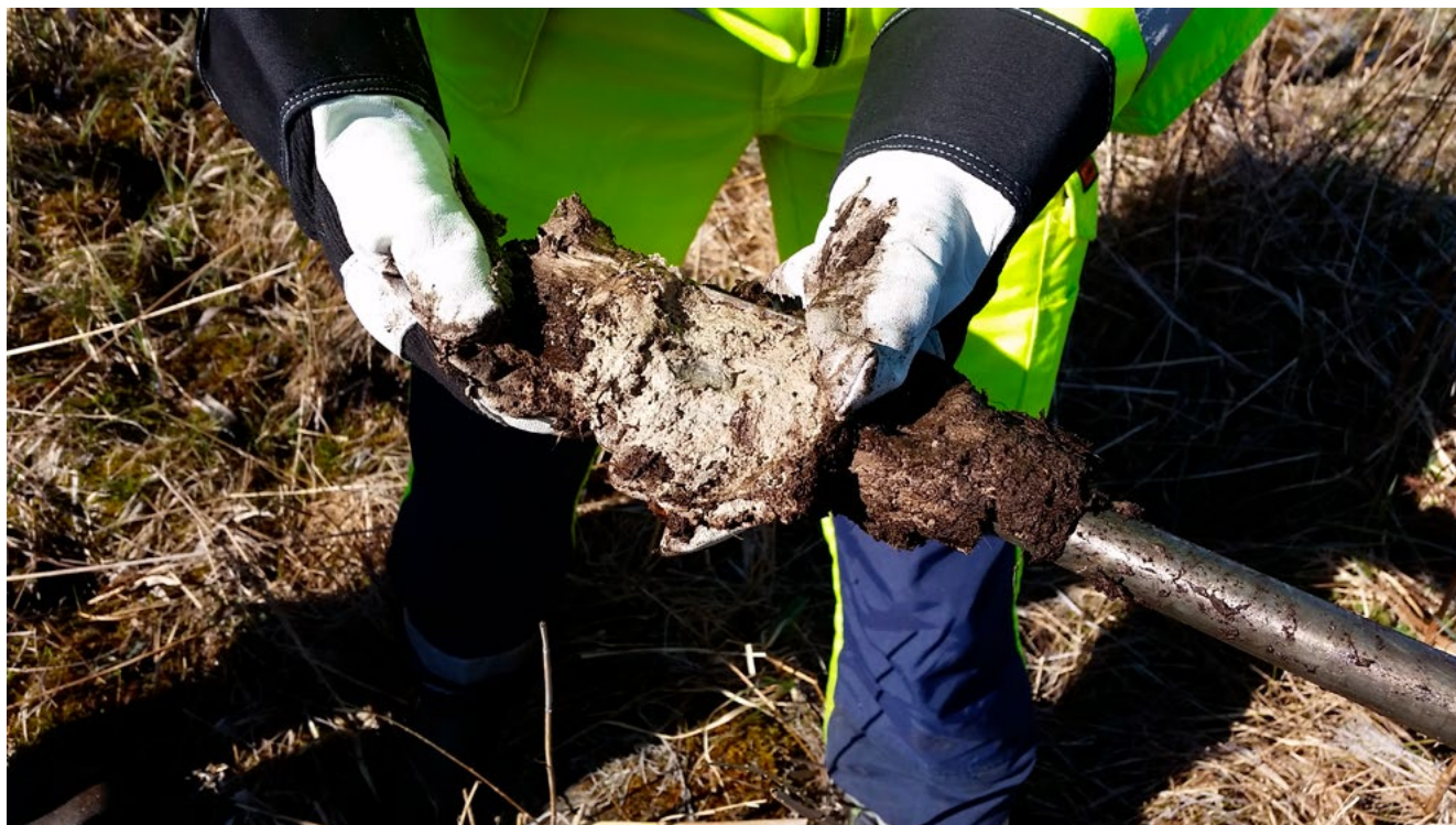
Figur 4.23. Här visas ett jordprov som tagits upp med provtagningsinstrument och där ett avvikande gråfärgat jordlager med förekomst av kalk framträder tydligt. För provtagning av jordart och jordartsprofiler förekommer att antal instrument med olika namn såsom markkarteringsborr, jordsond och jordborr. Jordsonden är enkel, smal och provet fastnar i en långsgående skåra i provtagaren. Den är lätt att ha med sig. Andra provtagare som den på bilden är något grövre och tyngre att ta med sig. Proven tas med den senare vanligen i en rörformad del som trycks ner i jorden (foto: Länsstyrelsen i Skåne).
