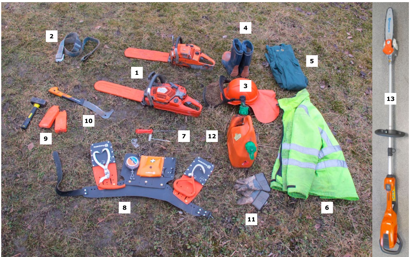
Figur 8.3. Exempel på utrustning för motormanuell avverkning. 1. Motorsåg. 2. Vändband, en hjälp vid fastfällning. 3. Huggarhjälm med hörselkåpor, visir och regnskydd. 4. Skyddsstövlar. 5. Huggarbyxor. 6. Varseljacket. 7. Fil, filmall och kombinyckel. 8. Huggarbälte med lyftsax, lyftkrok, måttband och förstaförband. 9. Slägga och fällkilar. 10. Röjkniv. 11. Huggarhandskar. 12. Dunk för 2-taktsbensin och kedjeolja. 13. Motordriven stängsåg för stamkvistning och för att kapa klena toppar över axelhöjd vid bekämpning av till exempel gråal (foto: Jesper Hansson).
