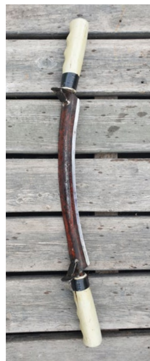
Figur 4.9. Bandkniv är ett enkelt, effektivt och lätt redskap för ringbarkning av lövträd under savningstiden. Denna tid infaller i princip under april och maj beroende på var i landet man befinner sig. Redskapet finns i några olika utföranden (foto: Jesper Hansson).
