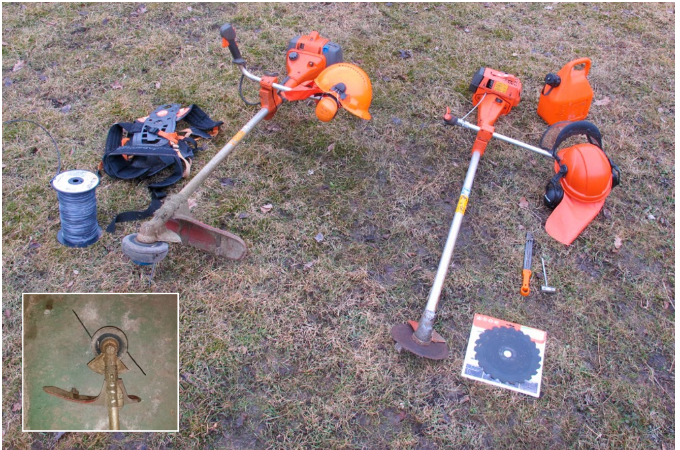
Figur 8.2. Utrustning för motormanuellröjning och slåtter. Röjsågen till vänster är utrustad med trimmerhuvud för grässlåtter och röjning av mycket klen sly (<1 cm i diameter). Trimmerhuvudet, infällt nere till vänster, måste kontinuerligt fyllas på med ny trimmerlina vartefter den nöts ner. Till höger ses en röjsåg utrustad med vanlig röjsågsklinga för slyröjning. Utöver det ses röjsågssele, fil med mall, hylsnyckel, hjälm med visir och hörselskydd och bensindunk. Observera att man alltid ska ha visir eller skyddsglasögon vid användande av röjsåg (foto: Jesper Hansson).
