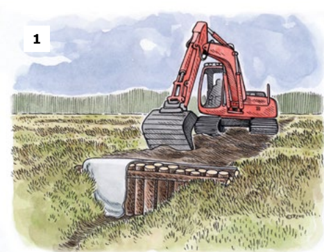
Figur 4.18. Jutesäckar som fylls med material tillgängligt nära dämmningsplatsen (torv) kan bli ett enkelt och flexibelt dämme som förankras med trästolpar huggna på plats. Dämnet kan till exempel användas vid komplettering och reparation av andra dämmen och dämning i små och känsliga källmiljöer (illustrationer: Tupu Vuorinen).
