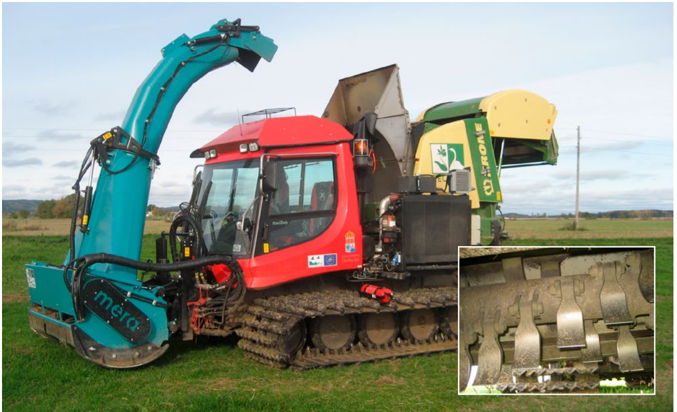
Figur 8.8. Pistmaskin, PistenBully 300 GreenTech, utrustad med slåtteraggregat och med balpress bakom styrhytten. Infälld är en närbild på de slagor som slår av gräs, starr, örter och förekommande sly (foto: Jesper Hansson).
