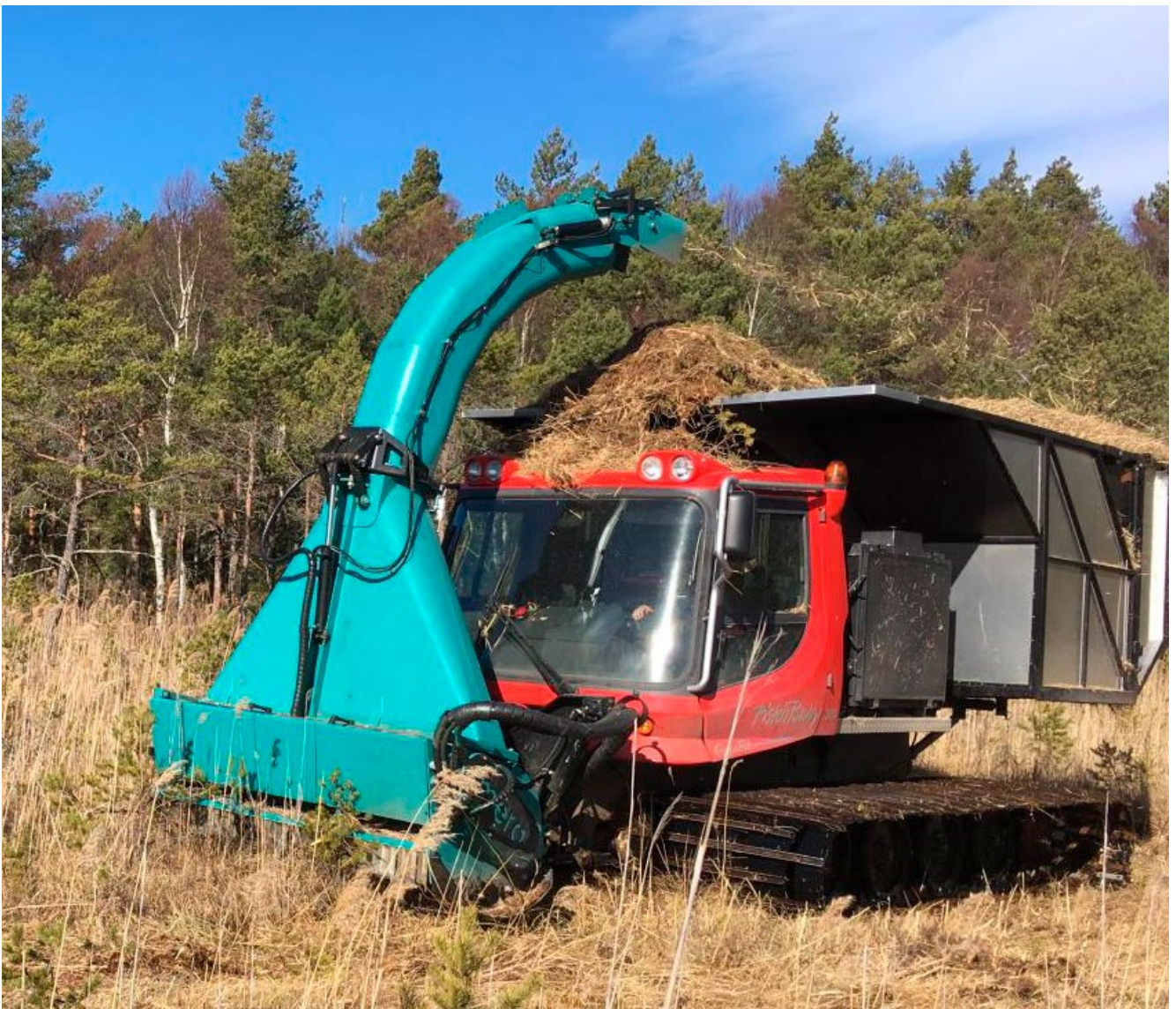
Figur 8.7. Pistmaskin, PistenBully 300 GreenTech, utrustad med slåtteraggregat som även tar glest sly på en diameter på upp till 5 cm, och blåser ner det i en balja bakom styrhytten (foto: Länsstyrelsen i Uppsala län).
