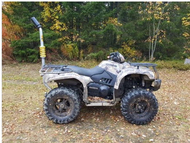
Figur 1. Fyrhjuling med Quadbar flexi. Foto: Tomas Nordfjell
