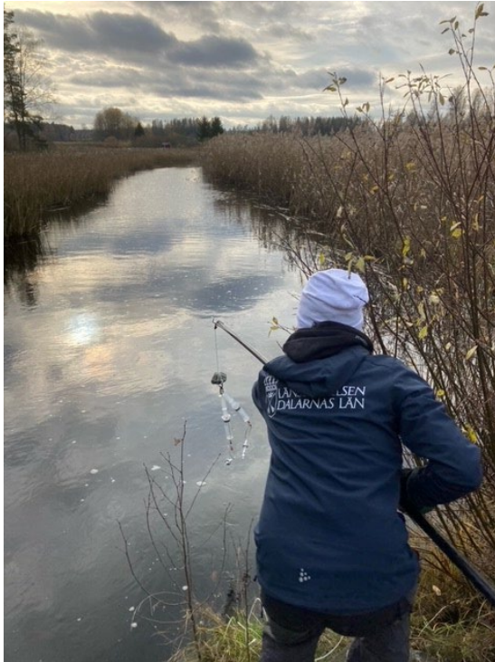
Figur 4. Utplacering av två TIMFIE-provtagare i Forsån, Dalarna. En TIMFIE med SPE-kolonner och en utan SPE för jämförelse av metallhalter och DOC. En sten valdes som sänke och på bilden syns även det modifierade metspöt som används för säker och enkel utsättning och upptagning. Foto: Anna Wemming.
