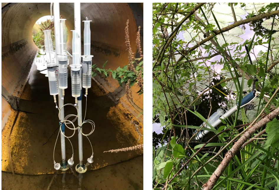
Figur 6. TIMFIE monterade på aluminiumskaft och utplacerade i en vägtrumma i provpunkten nedströms avfallsanläggningen, vänster, och i Hörsne på Gotland till höger. Det vänstra fotot visar fyra parallella provtagare, tre med SPE-kolonner och en utan SPE, för metodvalidering av organiska föreningar och metaller. Observera vattendjupet som här endast var cirka 8 cm. Foton: Ove Jonsson, vänster, Emelie Vejls, höger.
