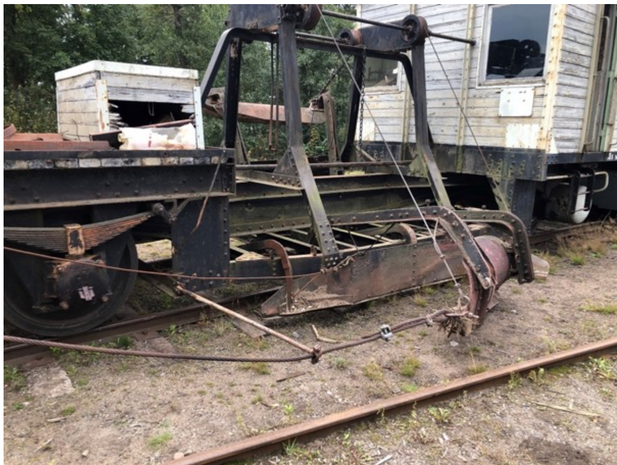
Figur 5. Närbild av Q20-vagn. Vagnen dras av lokomotiv och plogarna på vardera sidan av vagnen kan höjas och sänkas m h a tryckluft från loket.
