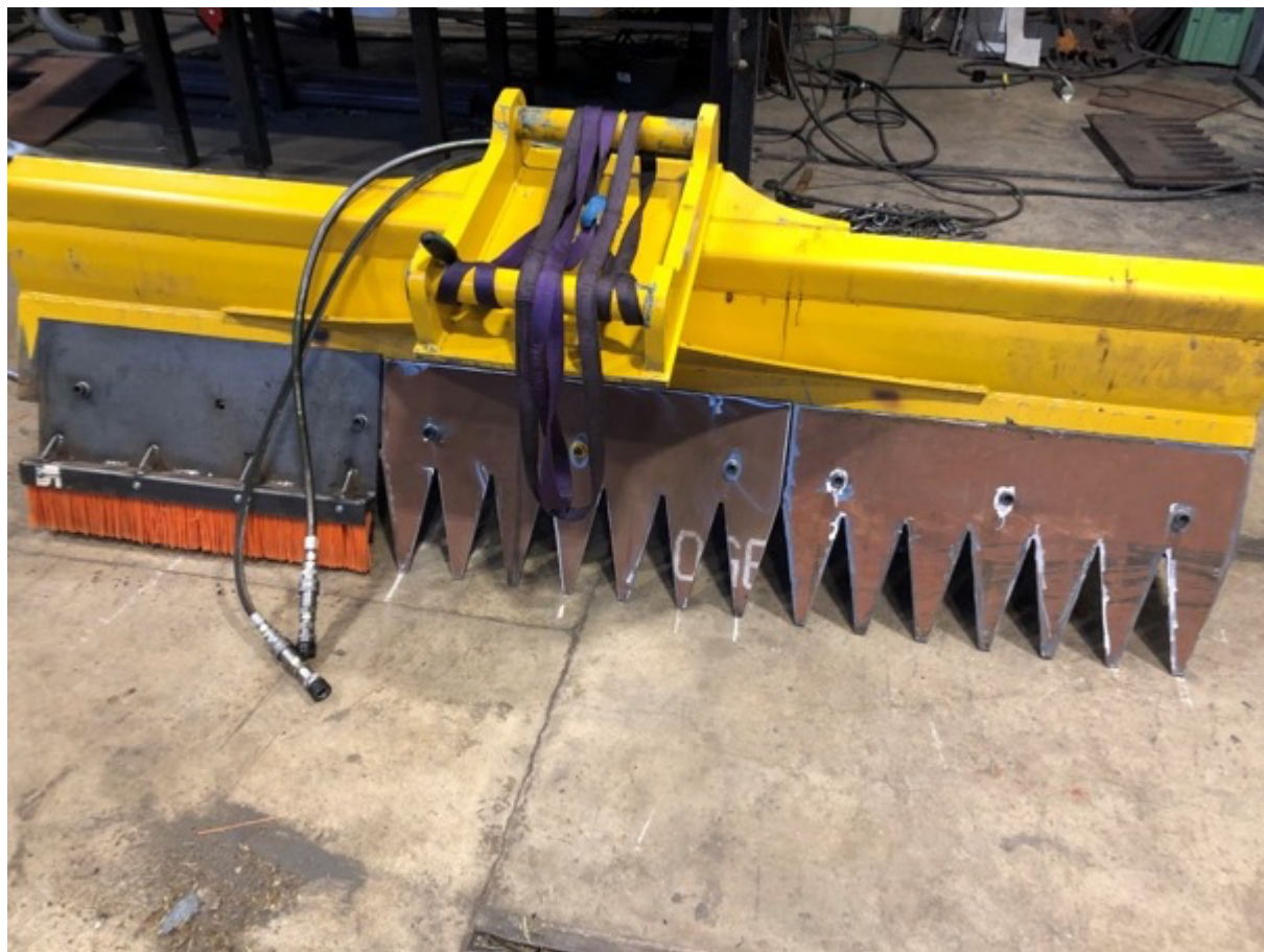
Figur 16. Den rivande/krattande sidan möjliggör borttagning av kraftig vegetation. Rivsidan består av tre enheter som kan bytas ut och ges grövre eller finare tandning eller en grov borste för att kunna rensa sliperskanten från grus mm.
