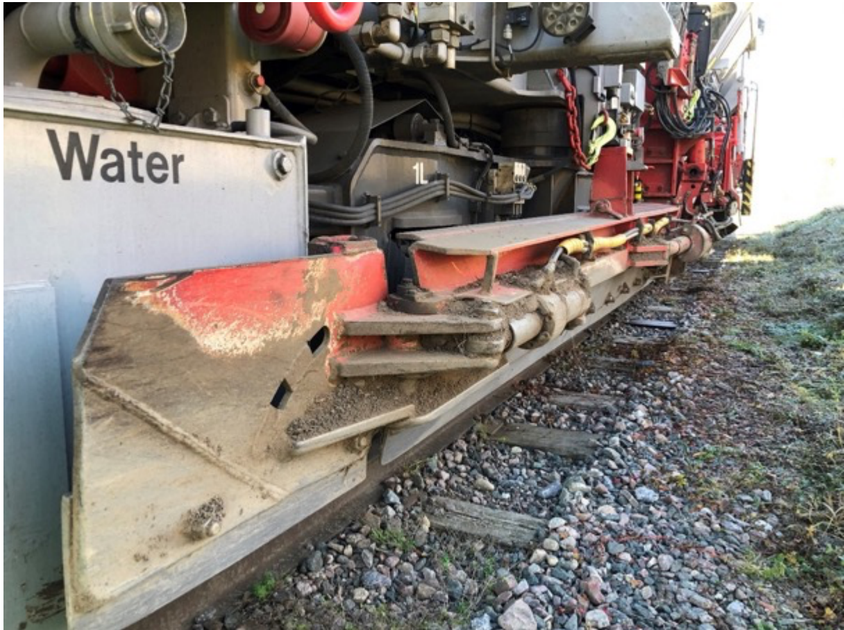
Figur 13. Skrapvinge på ballastplog PLB 6511W.
