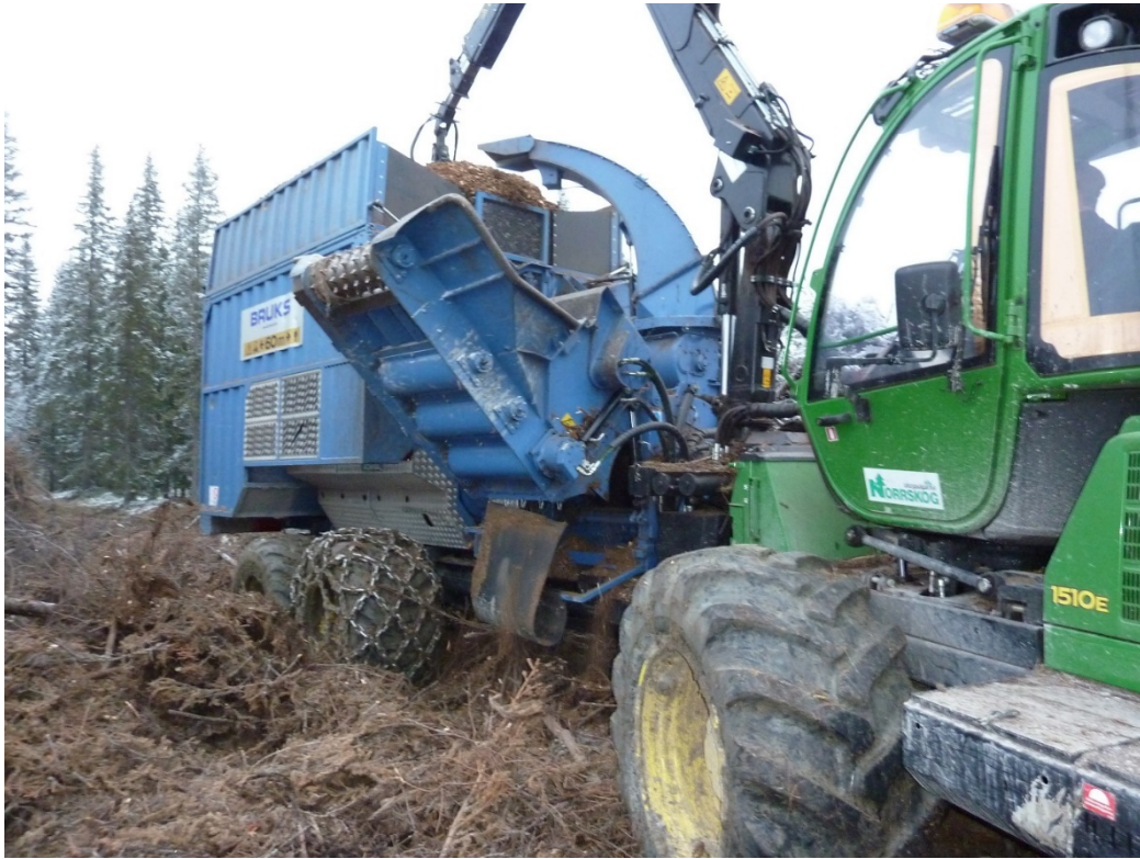
Figur 28. En terränggående flishugg som i detta fall transporterar det sönderdelade materialet från hygget fram till bilväg. Foto: Tomas Johannesson.
