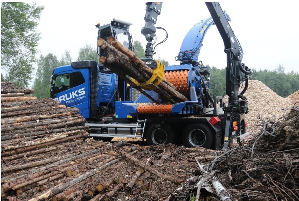
Figur 35. Större trumhugg vid sönderdelning av rundved på terminal. Foto: Lars Eliasson.
