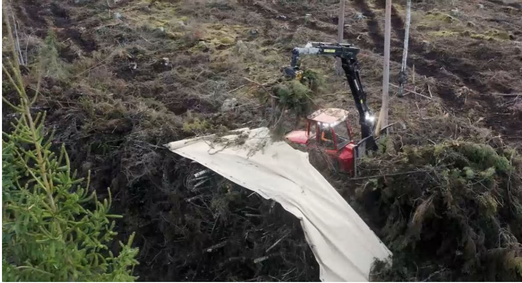
Figur 19. Skotare som täcker en grotvälta med täckpapp och förankrar med ris ovanpå. Foto: Skogsstyrelsen.
