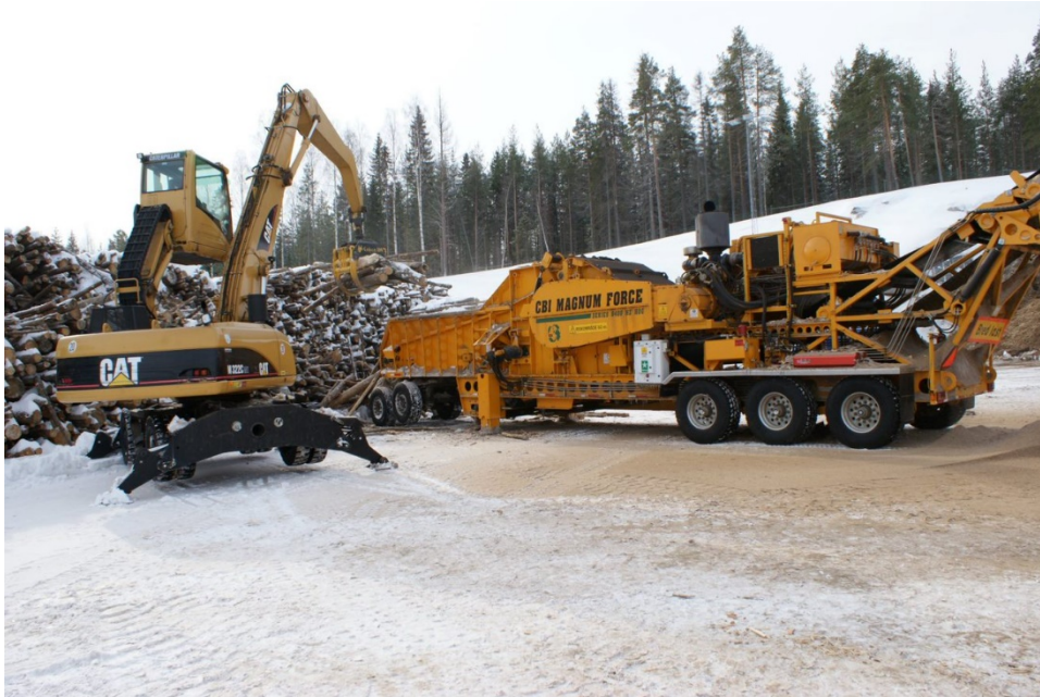
Figur 36. Stor terminalkross vid sönderdelning av rundved på terminal. Foto: Lars Eliasson.
