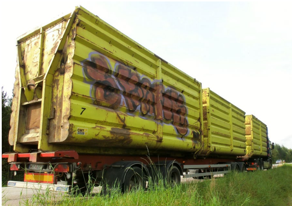
Figur 31. Containerbils ekipage med tre st. 40 m 3 containrar. Lastbilen är utrustad med lastväxlar-system för att kunna hantera containrarna vid av- och pålastning. Foto Anders Eriksson.
