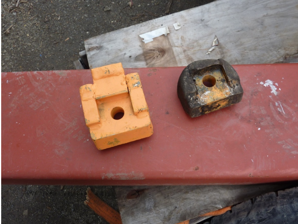
Figur 24. Bilden visar en ny kross-sлага till vänster och en utsliten kross-sлага till höger i bild. Kraftigt slitna slagor påverkar prestation och kvalitet på det krossade bränslet. Foto Tomas Johannesson.
