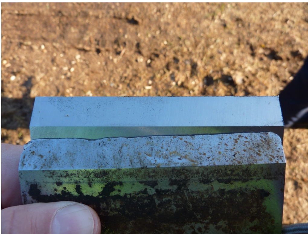
Figur 22. En ny huggkniv (överst) och en sliten huggkniv (nederst) i bild. Den nedre har ett normalt slitage. Foto: Tomas Johannesson.
