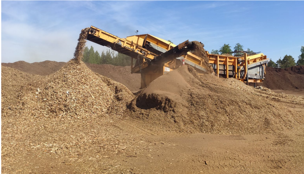
Figur 38. Stjärnsikt som delar upp grothflis i en rejektfraktion och en acceptfraktion. Foto: Anders Eriksson.
