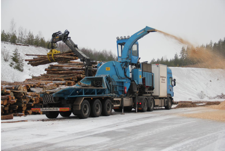
Figur 34. Stor skivhugg som sönderdelar rundved på terminal. Foto: Lars Eliasson
