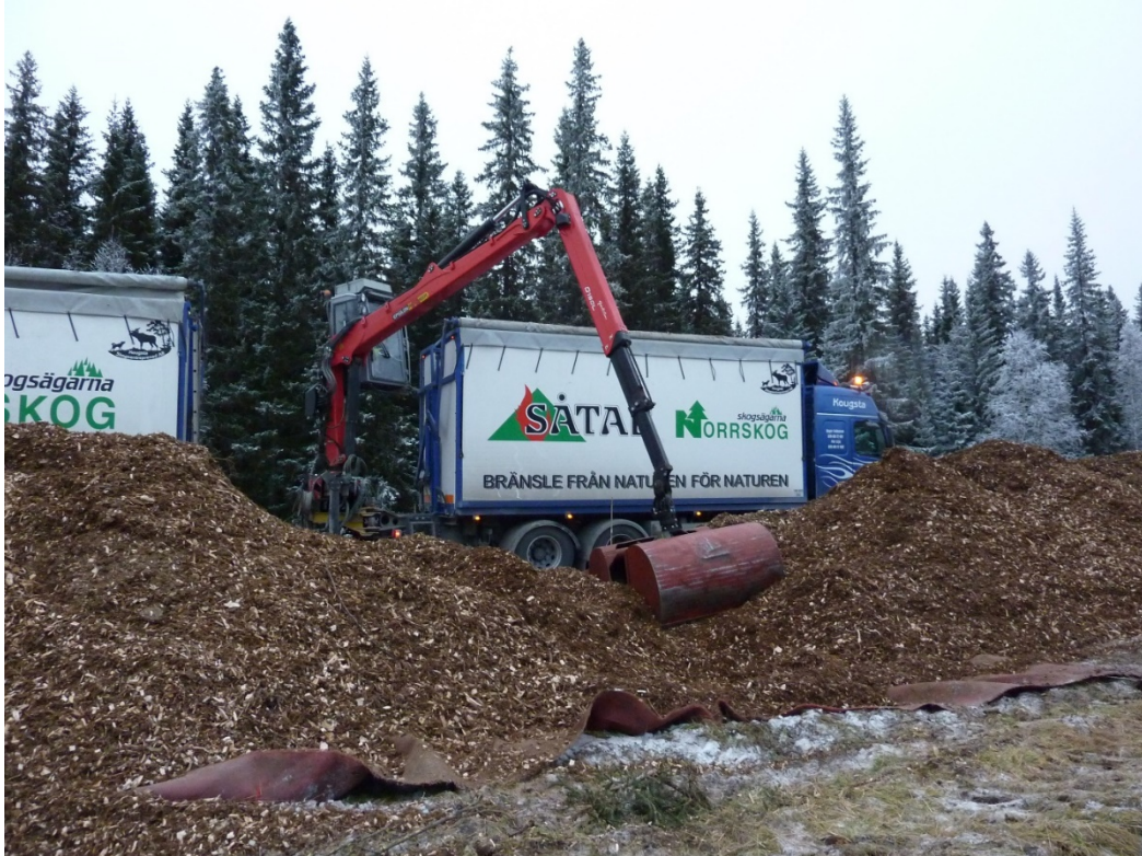
Figur 29. Skopbil som lastar grofflis. Flishögen som är placerad på en markduk har tippats direkt från flishugggen. Foto: Tomas Johannesson.
