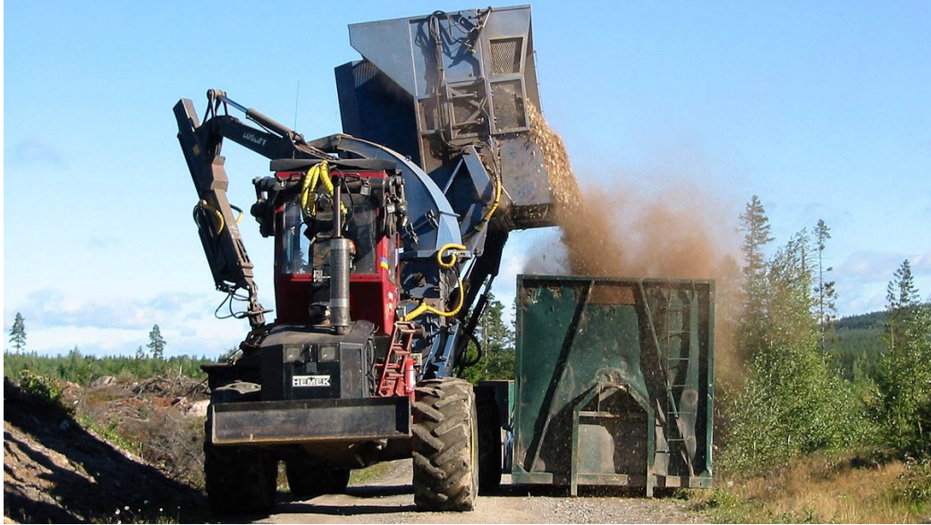
Figur 30. Traktormonterad hugg som fyller en container med grothugg. Containern transporteras därefter med lastväxlarbil till mottagaren eller terminal. Foto: Rolf Björheden.
