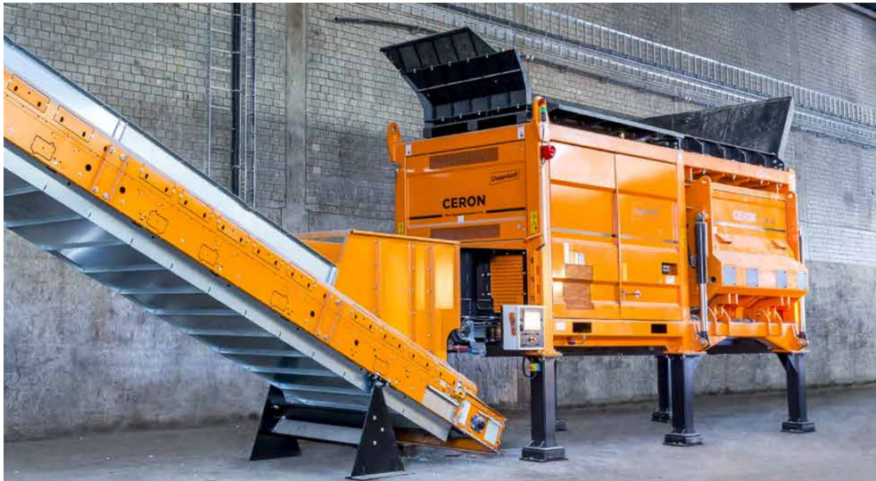
Figur 37. En stationär elektrisk valskross för sönderdelning av olika material. Foto: Doppstadt.
