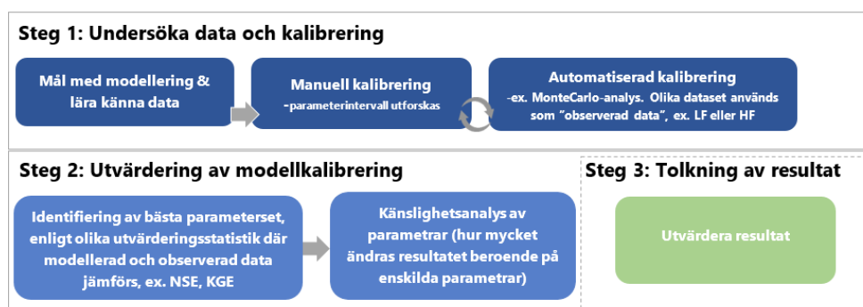
Figur 1. Ett exempel på hur arbetet med en modell kan utföras. Lågfrekvent data (LF) eller högfrekvent data (HF) kan användas för kalibrering. Ett eller en grupp parameterset kan användas för att visualisera resultatet.
