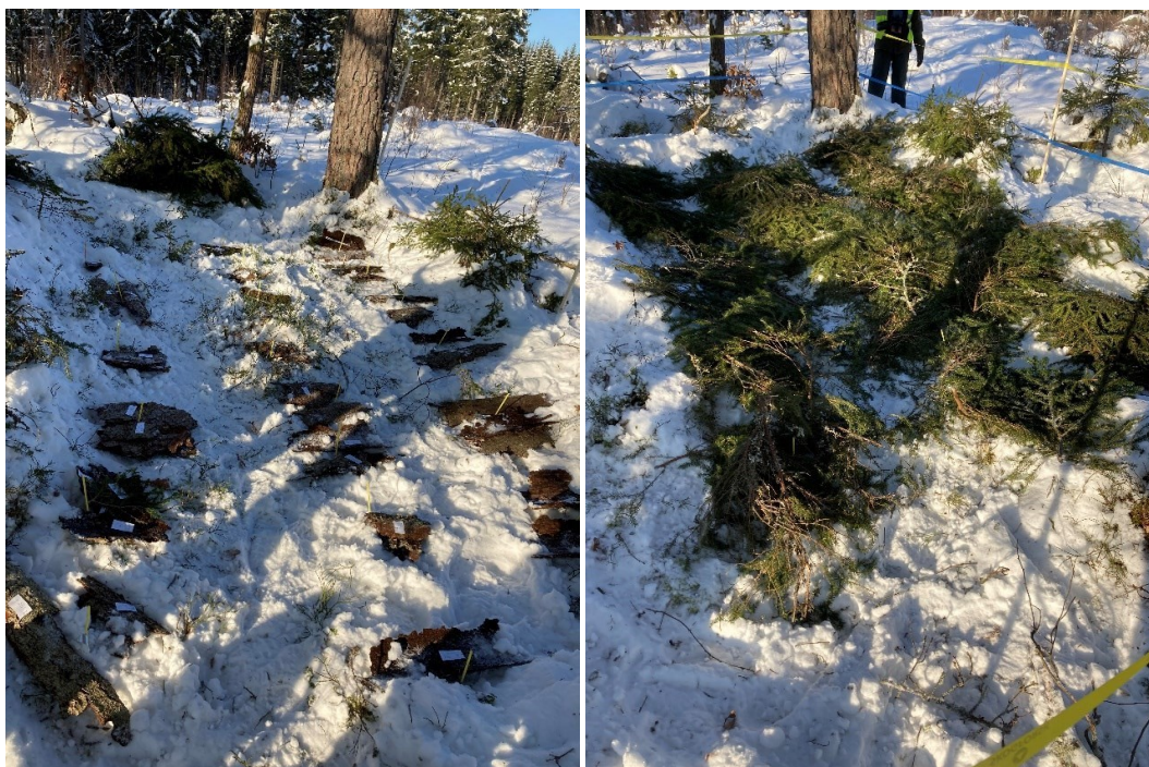
Figur 2. Barkprover lagda på marken vid Krokshult II. Barkproverna från vartannat träd lades med yttre barksidan uppvänd och från vartannat träd med yttre barksidan nedvänd mot marken och därefter täcktes de med ett tunt lager granris. Barkbitar lades ut på tre olika platser: Krokshult I, Krokshult II (där också proverna från Oxlehall lades) och Fjällnora.
